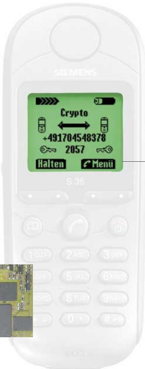
Im Krypto-Mode vereinbart Ihr TopSec GSM mit der TopSec-Gegenstelle automatisch bei jedem Anruf einen neuen 128-bit-Schlüssel. Dabei wird nach dem Zufallsprinzip einer aus  $10^{38}$  möglichen Schlüsseln gewählt und nach Beendigung des Gesprächs sofort wieder gelöscht.
